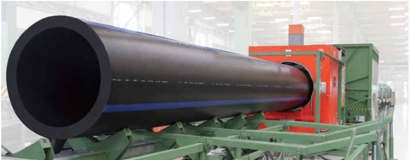
PE 100 Ø 1200 mm PN 16 boru et kalınlığı 109.1 mm’dir.
